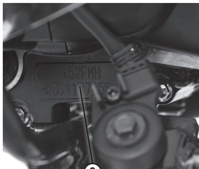
Рис. 1 Расположение номеров двигателя и рамы
