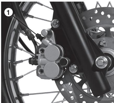
Рис. 12 Дисковый тормоз переднего колеса
